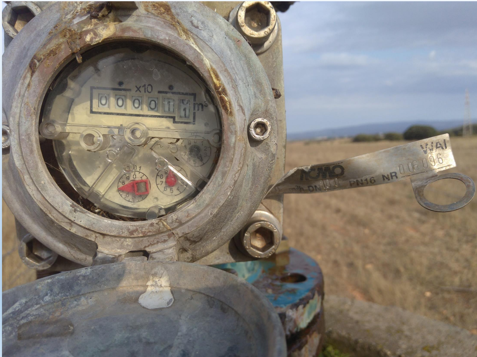
Domanda irrigua – contatori x 10 – dettaglio matricola
